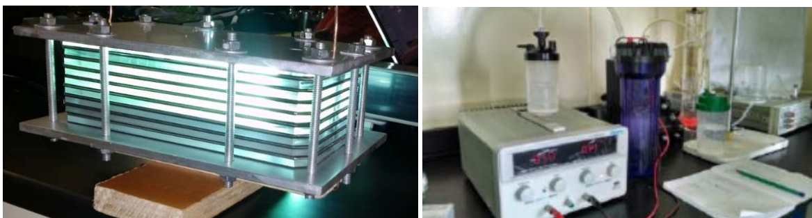
Fig. 1. a) Alkaline electrolyzer b) Test system.
